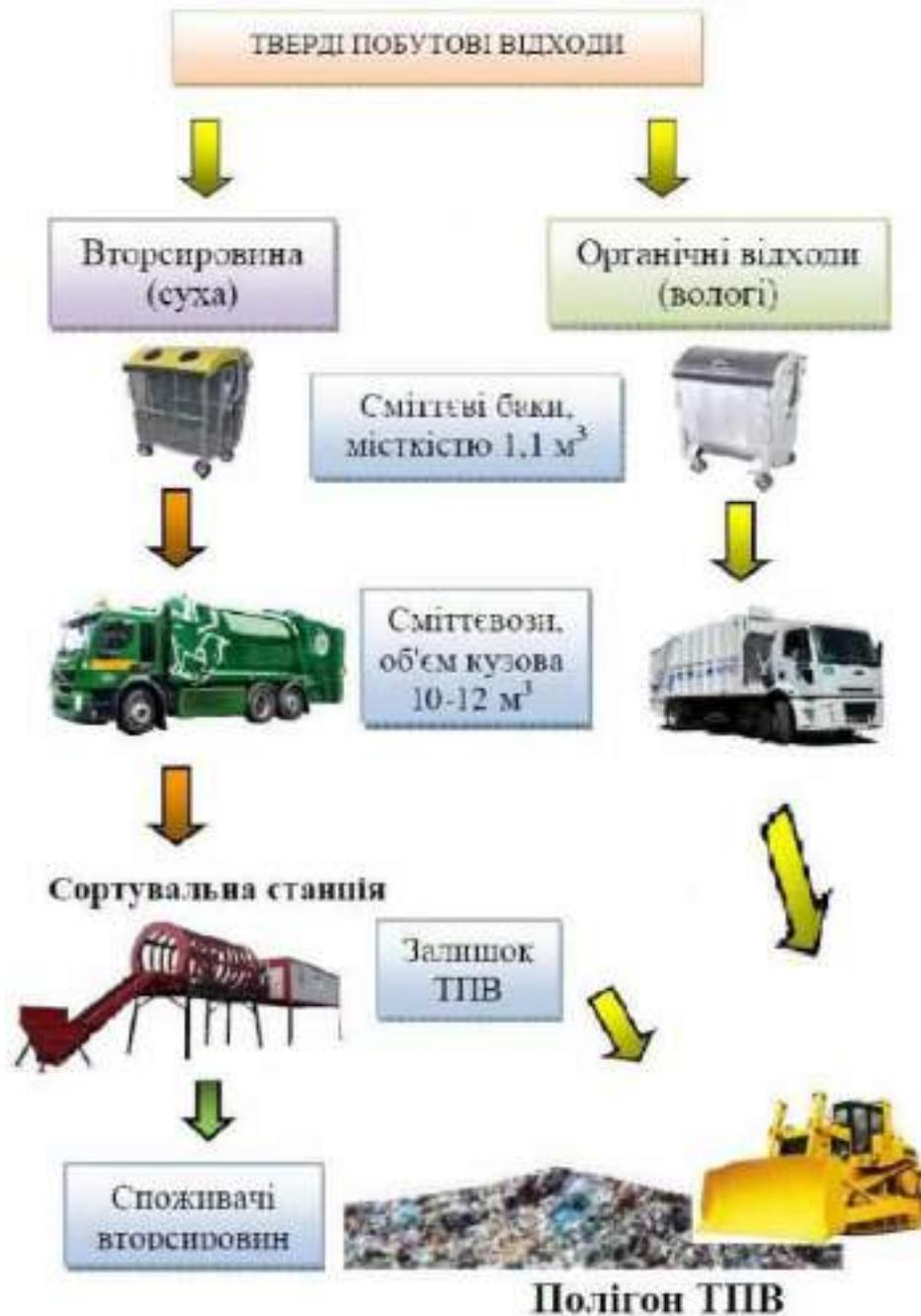
Рис. 2.1 Схеми сортування ТПВ на 2 потоки
