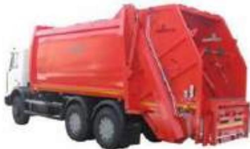
**Сміттєвоз КО-427-34 (МАЗ-5340С2 евро5)** - для механізованого та ручного навантаження, для контейнерів 0,12 - 1,1 м<sup>3</sup>, а також порталний перекидач для бункерів до 8,0 м<sup>3</sup>. Об'єм бункера 16 м<sup>3</sup>, коефіцієнт пресування 5-6, маса ТПВ 7300 кг, повна маса 19500 кг.
