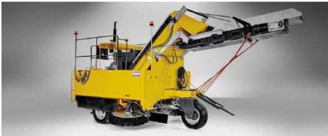
Ергономічний пульт управління під'єднується через гнучкий кабель і може бути встановлений в кабіні водія для зручного управління прибиральною машиною. Друга панель управління розташована безпосередньо на машині.
